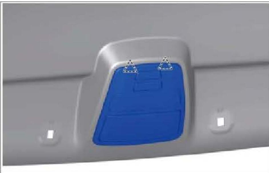
分离 2 个卡爪并拆下前室内灯总成。
