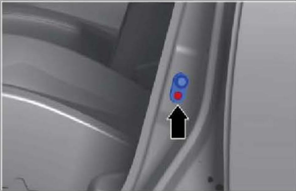
拆下螺钉并取下前门门控灯开关。
